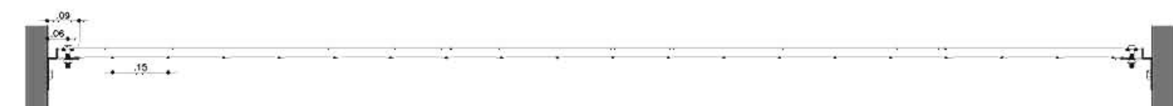
GRELHA METÁLICA ELETROFUNDIDA DETALHE 2 SCALA 1:10
