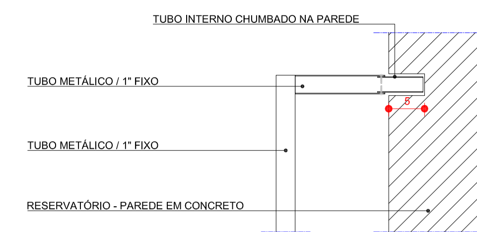
DETALHE FIXAÇÃO EM PARADE EM CONCRETO ESCALA 1/5
