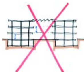
pavimentos nivelados o perfil do de entrada é convencional e o percurso vertical entre os andares superiores é sempre de 2m
